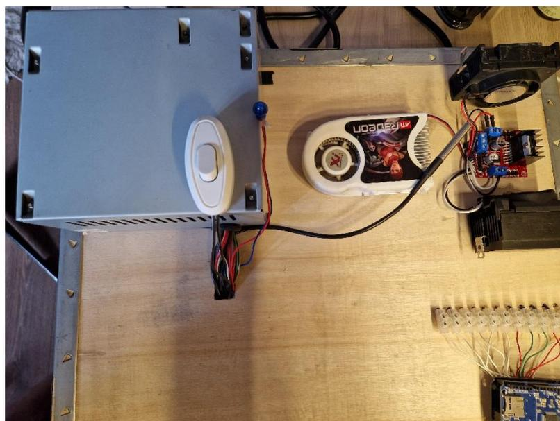
Рисунок 3.6.5 – Дополнительные элементы макета (блок питания, тумблер на питание и светодиод)
