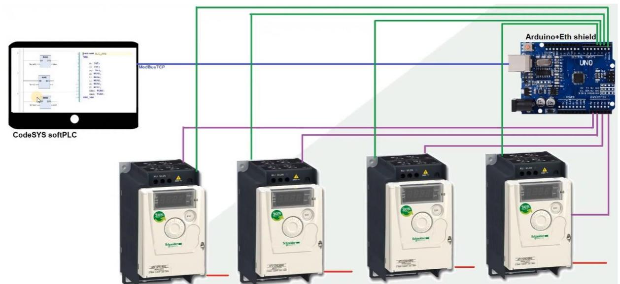
Рисунок 2.2.2 – Коммуникация VFD устройств к PLCduino по протоколу Modbus TCP
