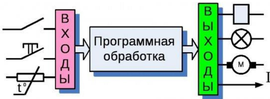
Рисунок 1.1.2 – Принцип работы ПЛК в виде визуальной схемы
