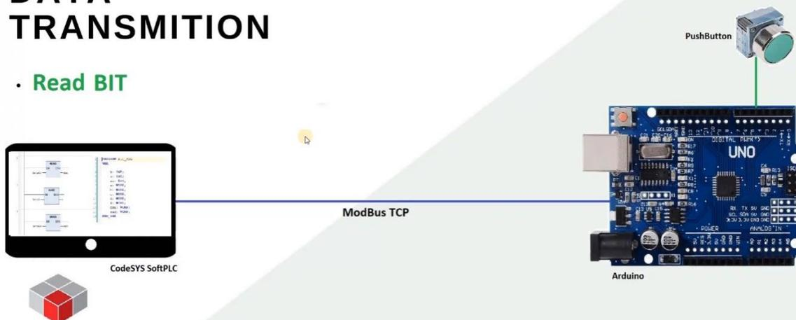
Рисунок 2.2.1.4 – Read BIT на примере с кнопкой
